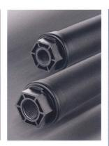
Sistemi di aerazione per applicazioni in vasche in impianti di trattamento acque civili ed industriali. Questi sistemi sono destinati all'aerazione di acque reflue tramite aria compressa a bolle fini in vasche di fanghi attivi. Le membrane in gomma EPDM consentono di effettuare operazioni intermittenti grazie alla loro elasticità a lungo termine.
