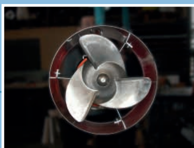
Pompa di ricircolo Recirculation pump
